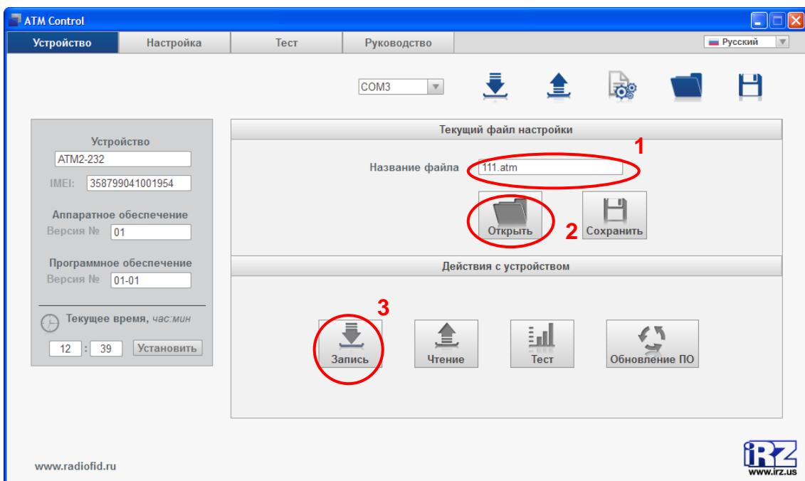
**Рис. 5.1** Вкладка «Устройство» — кнопки «Открыть» и «Запись»
